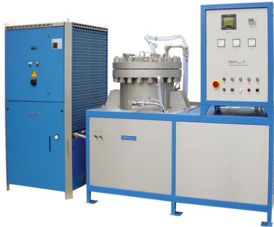
Bild 14 Rubistar Spezial in Ausführung als Toplader. Links das Umlaufkühlaggregat
