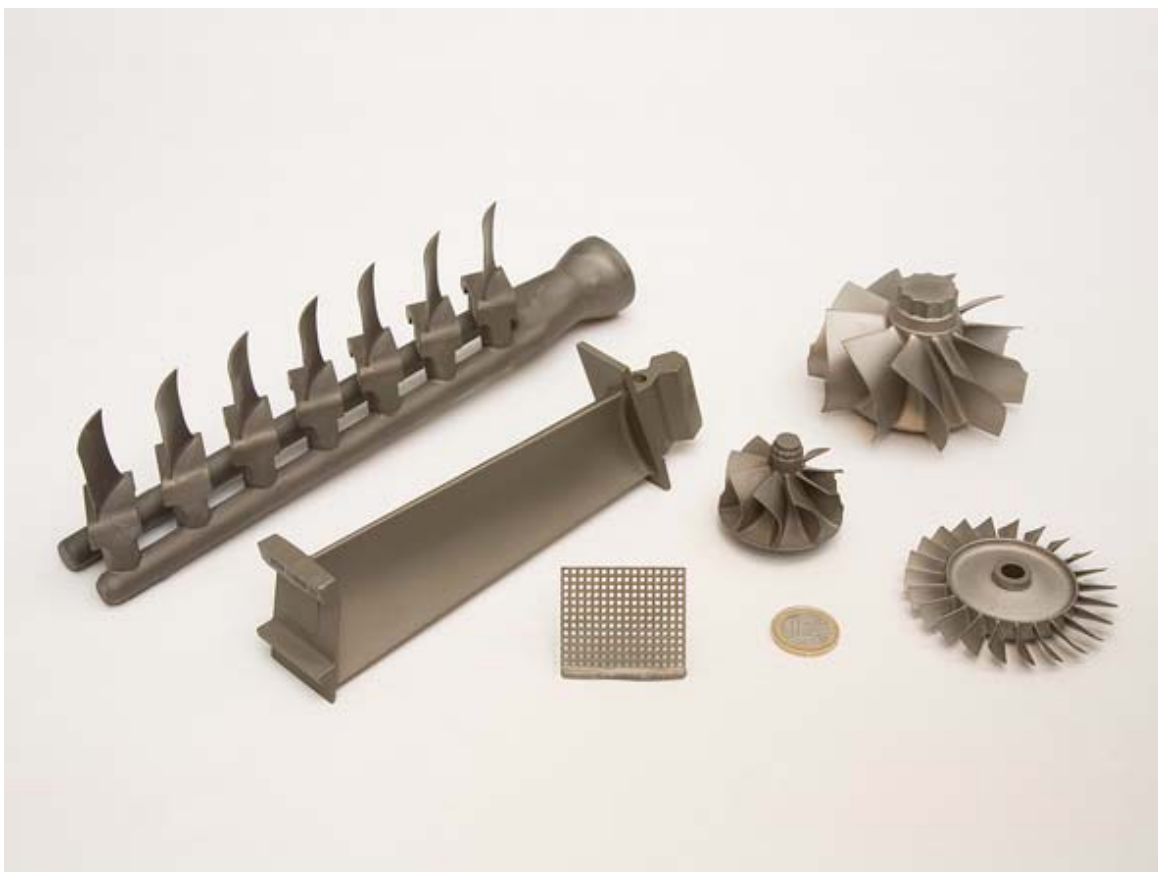
Bild 1: Turbinenschaufeln, ein Gießtest-Gitter und Turboladerräder aus TiAl Mit einer Euro-Münze als Größenvergleich
