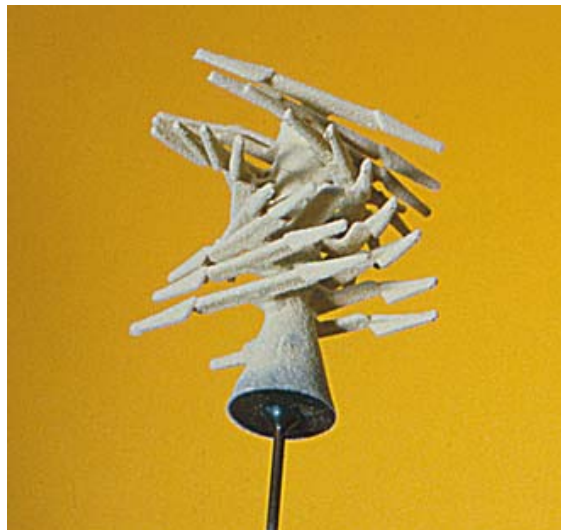
Bild 9: Modelltraube nach mehrmaliger Besandung
