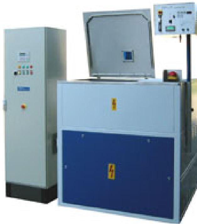
Bild 4: Induktions-Schleudergießanlage Supercast mit Mittelfrequenz-Generator
