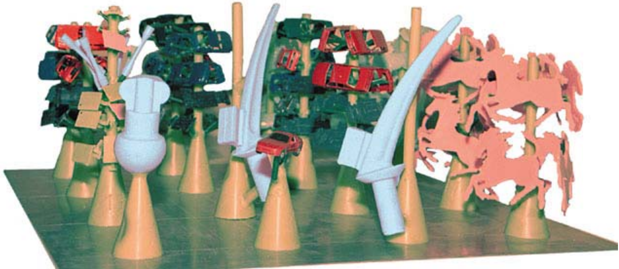
Bild 8: Wachsmodelle zu Gießtrauben präpariert
