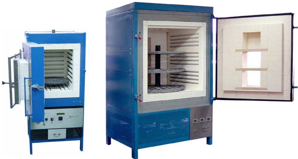
Bild 10: Drehherdöfen für Gießformherstellung oder Wärmebehandlung
