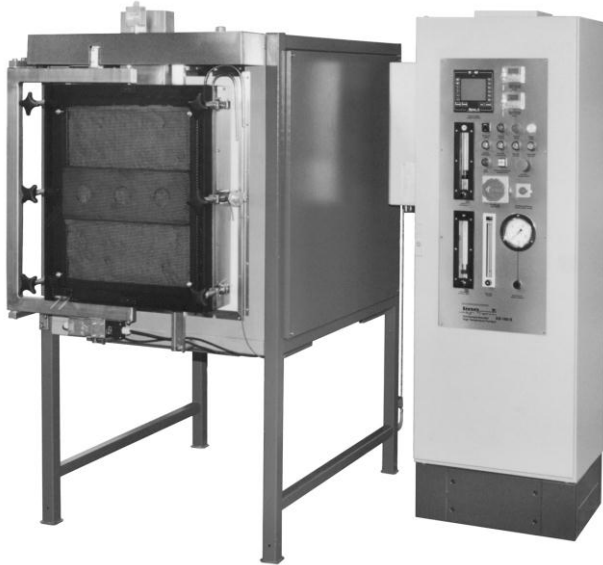
Bild 5: Schutzgasdichter Kammerofen 480 Liter / 1100°C (Foto Linn High Therm)
