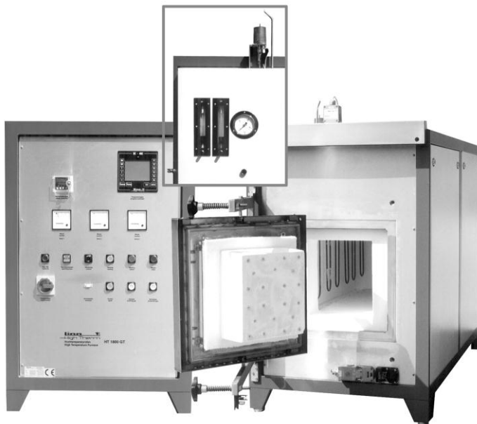
Bild 2: Schutzgasdichter Hochtemperaturkammerofen 52 Liter / 1820°C (Foto Linn High Therm)
