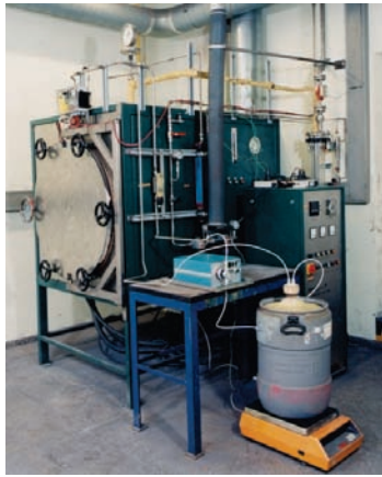
Spezialofen zum katalytischen Entbindern ( T_{max} 180 °C), 800 l
