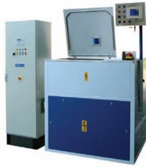
Supercast. Induktive Zentrifugalgießmaschine
