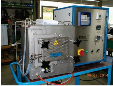
VMK-135-S (Tmax 1050 °C), schutzgas – und vakuumdicht, verschiedene Größen
