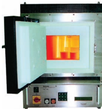
VMK 1400-1800 ( T_{max} 1820 °C), verschiedene Größen
