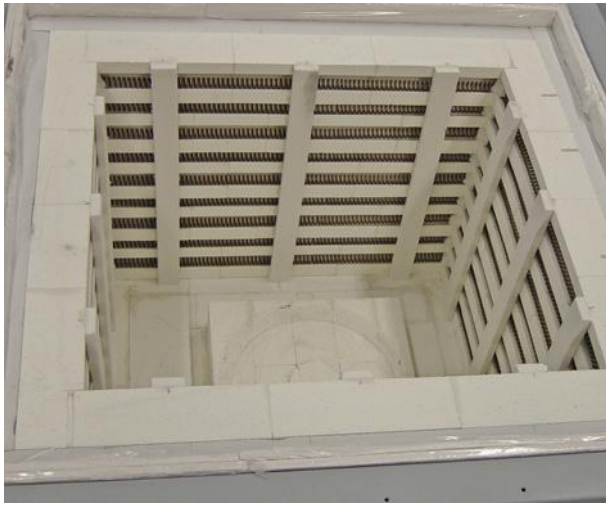
Bild 4.1-5 Ofenkammer mit eingelegten Heizspiralen und Tiegeluntersatz (Bild Linn High Therm)
