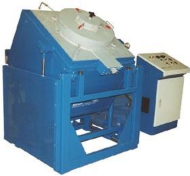
Bild 4.1-8 Tiegelofen TSWK zum Schmelzen und Warmhalten von Magnesium und Legierungen. Mit Begasungseinrichtung für SF 6 , mit hydraulischer Kippvorrichtung (Bild Linn High Therm)
