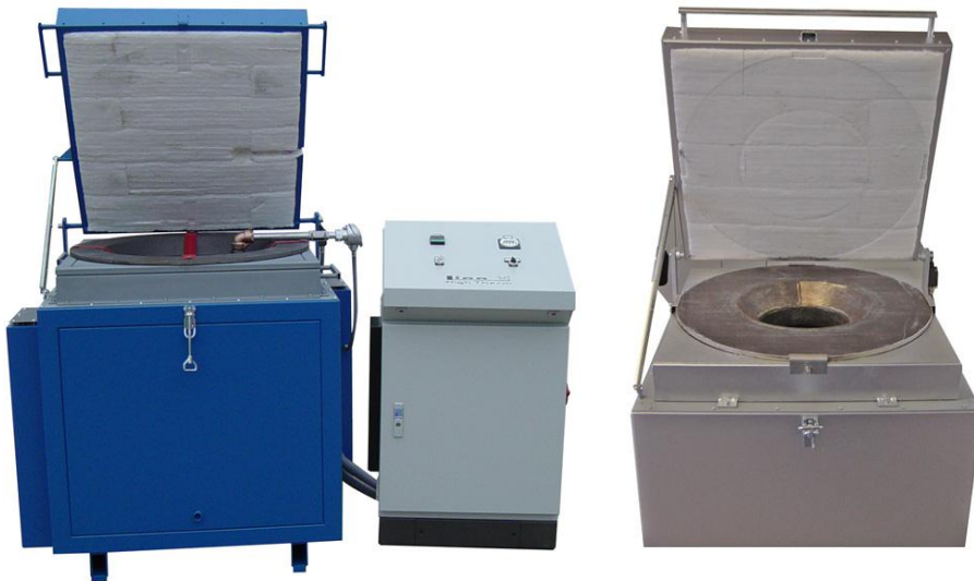
Bild 4.1-1 feststehende elektrisch widerstandsbeheizte Tiegelöfen (Bild Linn High Therm)
