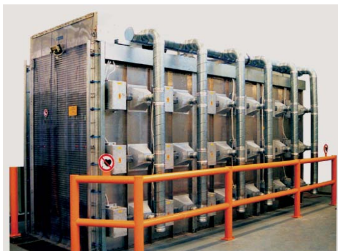
Bild 3: Mikrowellen Kammer Trockner (21 m 3 / 30 kW)
