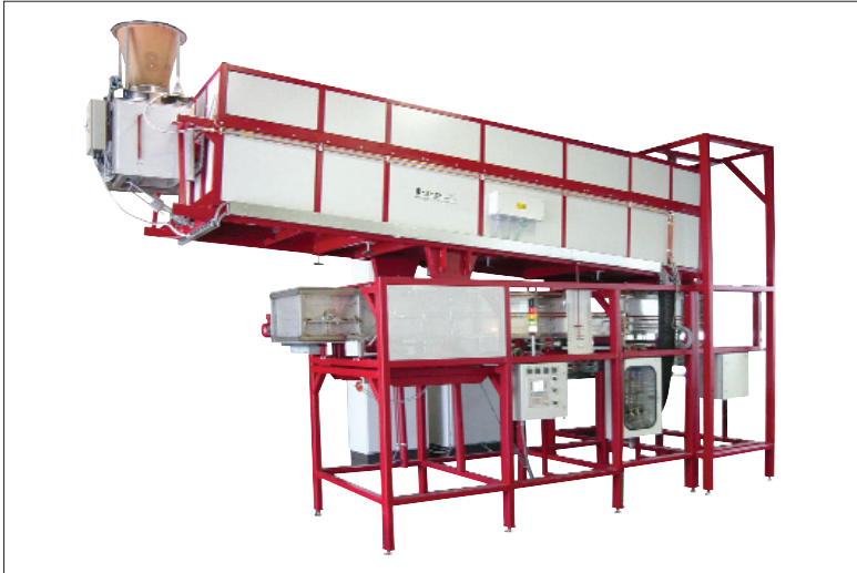
Bild 3 Drehrohrofenanlage mit integrierter Kühlstrecke 950 °C, mit Schutzgas
