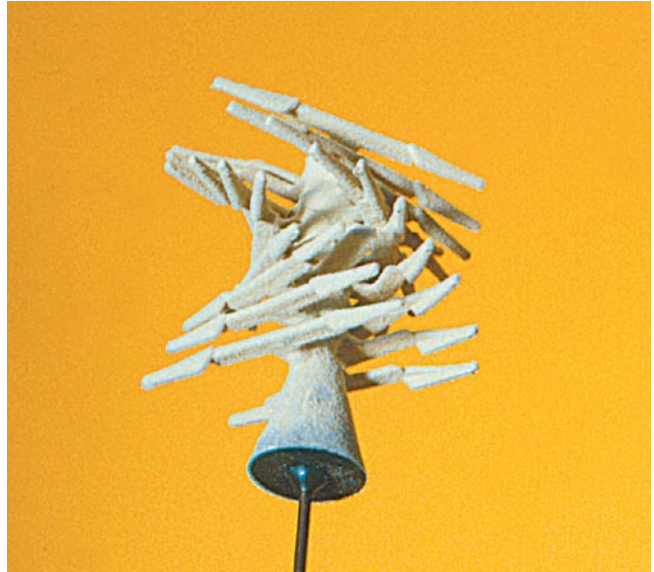
BILD 7 Modelltraube nach mehrmaliger Besandung
