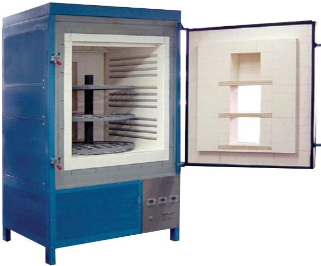
BILD 8 Drehherdöfen für Gießformherstellung oder Wärmebehandlung
